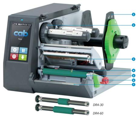
Des rouleaux d'impression étroits sont requis pour une impression précise avec les matières et rubans de faible laize. Cela permet d'éviter l'usure du rouleau, l'encrassement de la tête d'impression et les erreurs lors du transport de la matière.
