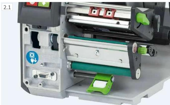
**Alle Druckköpfe sind bei gleicher Breite beliebig austauschbar. Sie werden von der CPU automatisch erkannt und kalibriert.**
